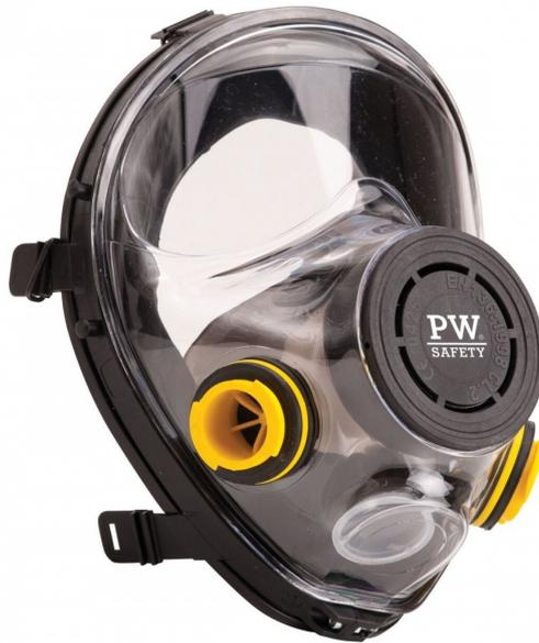
Maschera pieno-facciale con doppi filtri ad attacco a baionetta e porta-filtro in ABS. Il visore in policarbonato offre un ampio campo visivo ed è anti-graffio e trattato anti-appannamento. Bardatura ergonomica con sei fibbie a rilascio rapido. La bardatura è ancorata alla cornice rigida della maschera per garantire una aderenza uniforme sul viso. Filtri venduti separatamente.
