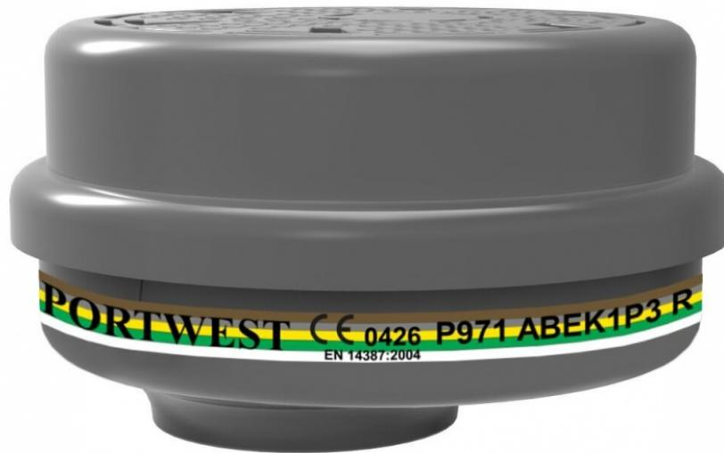
Questo filtro anti-gas e anti-particelle protegge da gas organici e inorganici e vapori acidi, anidride solforosa, ammoniaca e suoi derivati. Classificati come filtro di classe 1 per i gas e categoria 3 per particelle protegge contro sostanze nocive, solventi, particelle tossiche e microrganismi. Il particolare sistema a baionetta Portwest garantisce un collegamento sicuro tra la maschera e il filtro. Questo filtro è compatibile con la semimaschera P420,P430 e Maschere P500.
