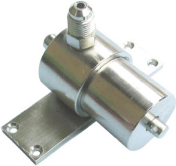
Costruito da un pistoncino che tiene aperto la serranda. In caso di passaggio del gas il pistoncino rientra permettendo la chiusura della serranda.
