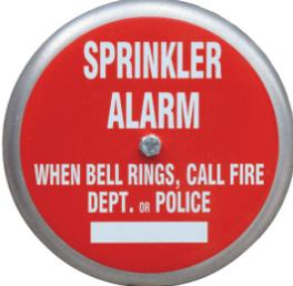
Azionata dal flusso dell'acqua in caso di funzionamento di uno sprinkler. E' dotata di motore idraulico munito di martelletto che fa suonare la campana. Funziona senza nessuna altra energia ma solo con il flusso dell'acqua. Si installa all'esterno dell'edificio.
