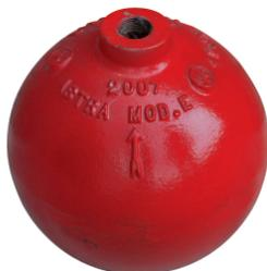
Si monta sul colpo valvola, ha lo scopo di evitare falsi allarmi della campana idraulica. Infatti in caso di fluttuazioni della pressione nella rete idrica può avvenire la temporanea apertura del piattello valvola anche in assenza di un reale flusso normalmente dovuto ad apertura di uno spinkler
