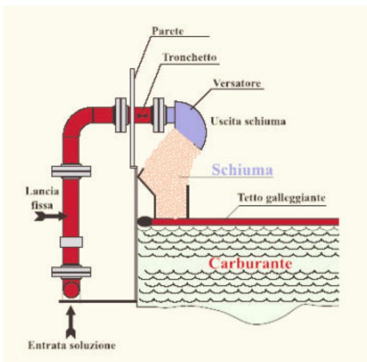
La lancia fissa è impiegata a protezione di serbatoi di stoccaggio liquidi infiammabili a tetto galleggiante. Inserita nella boccaporta del serbatoio. La schiuma viene erogata all'interno dell'anello in modo razionale, a bassa velocità. In acciaio al carbonio, finitura rosso epossidico. A richiesta zincato a caldo oppure in acciaio.
